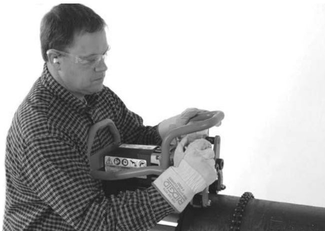
Рис. 10А – Затягивание зажимного винта от руки
