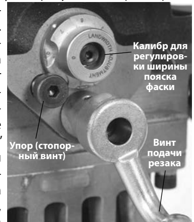
Рис. 12 – Установка калибра для регулировки ширины пояска фаски
