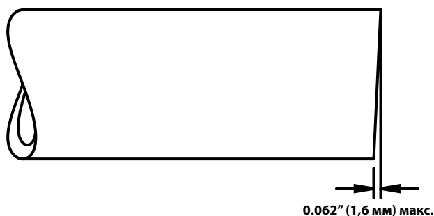
Рис. 6 – Требования прямоты трубы
