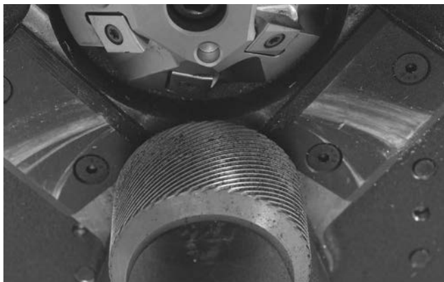
Рис. 16 – Чистые насечки ведущего ролика
